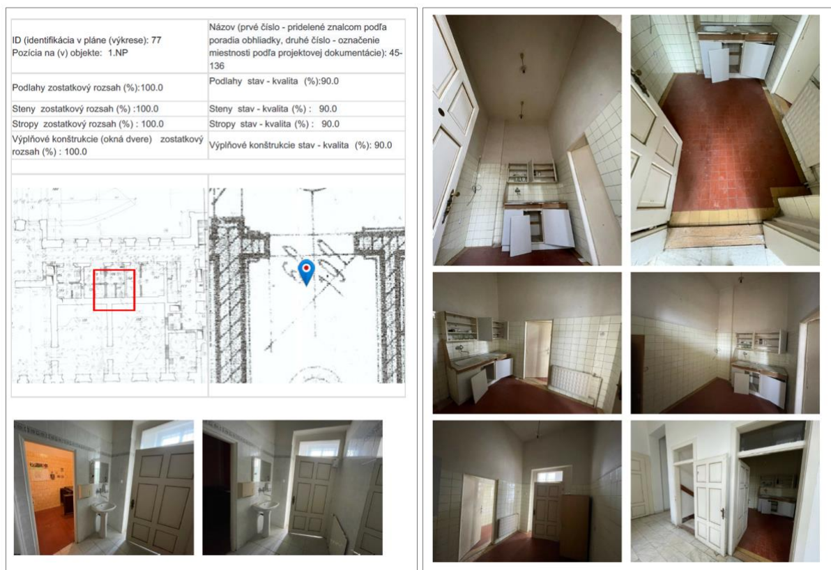
Obr. 3 Príklad výstupu z Planradaru použitého na posport objektu do znaleckého úkonu – popis a foto.
